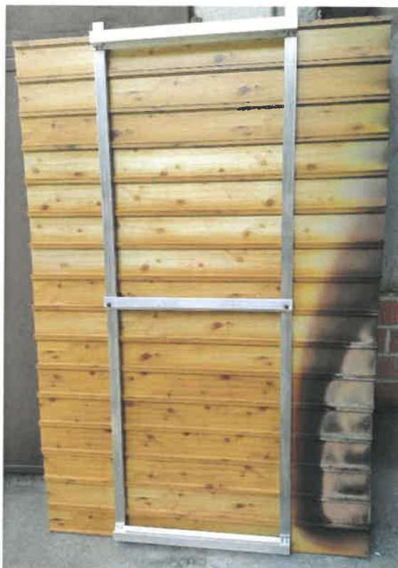
Pohled na vzorek po zkoušce z jeho zadní strany včetně hliníkového roštu
